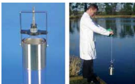
Ce préleveur est conçu pour le prélèvement de liquide, tel que l'eau, l'huile ou les boues.
