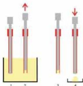
Ce préleveur est conçu pour le prélèvement de petite quantité de poudre (jusqu'à 0.1ml).
