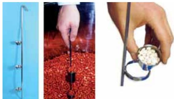
Ce préleveur est conçu pour réaliser un prélèvement en 3 niveaux pendant le remplissage d'un container.
