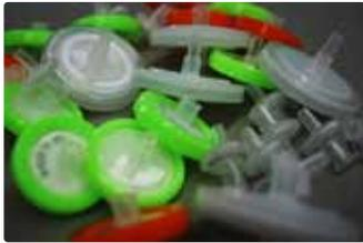
**Acétate de cellulose** : boîtier en polypropylène avec une membrane en acétate de cellulose hydrophile. **Applications** : Culture de cellules, de protéines et d'enzyme (stabilité chimique : pH 3-7).
