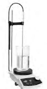
Les agitateurs magnétiques de la série Hei-Tec sont utilisés de préférence pour le mélange et le chauffage doux ou intense de fluides de faible viscosité.
