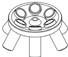
Rotor angulaire 6 x 50 ml avec godets 13276 pour tube 50ml Falcon
