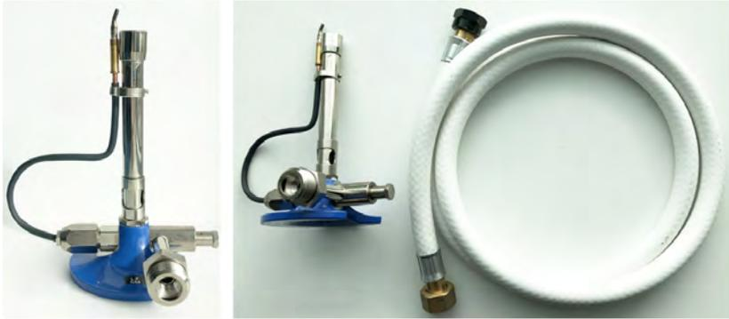
Bec de sécurité avec thermocouple coupant l'alimentation de gaz après 20 secondes en cas d'extinction de la flamme
