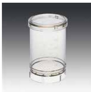
Système complet stérile constitué d'un entonnoir de 100 ml, d'une membrane filtrante amovible de 47 mm de diamètre et d'un support de milieu de culture.
