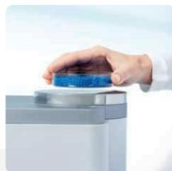
L'échantillon est directement déposé dans la coupelle puis positionné sur la cellule de mesure du spectromètre.
