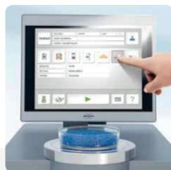
Pour sélectionner le produit, appuyer sur l'icône du produit respectif ou en utilisant le lecteur de code-barres.
