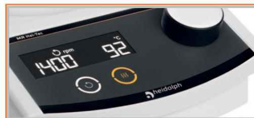
La plaque chauffante **Kera-Disk** en aluminium offre des temps de **chauffe rapides** et le **revêtement en céramique** très fin rend la plaque **résistante aux produits chimiques et aux rayures** !
