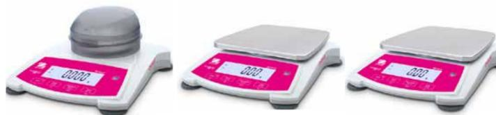
Ces balances fonctionnent avec 4 touches pour une utilisation plus facile. Applications: pesage, densité, masse molaire, crochet de pesée sous la balance...
