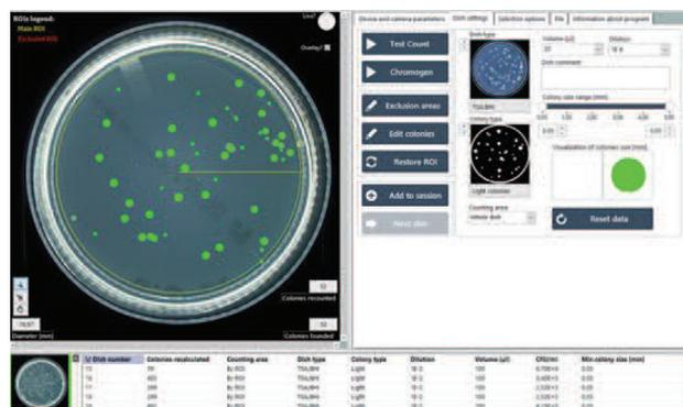
Quantica 500™ permet le **comptage automatique de colonies** sur milieu enrichi, sur gélose sélective ou chromogène dans les analyses microbiologiques.
