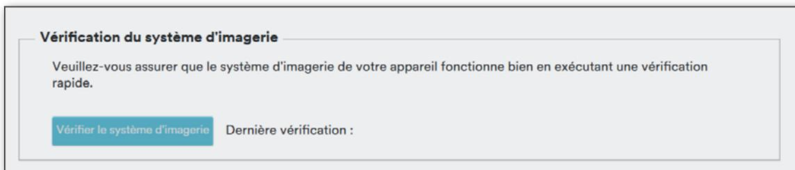
Cliquez sur **[Vérifier le système d'imagerie]** pour lancer le processus de vérification et obtenir le statut de la compensation dynamique. La date et l'heure du dernier cycle de vérification réussi sont ensuite affichées. Une fois la vérification terminée, le message **Vérification du système d'imagerie réussie** s'affiche.
