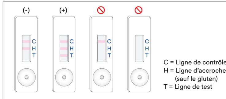
Toute lecture après 12 minutes suivant l'application initiale de l'échantillon dans le LFD 3M Protéine Lait entier de vache doit être considérée comme non valide. Une telle lecture ne peut pas être interprétée et peut conduire à des résultats erronés.
