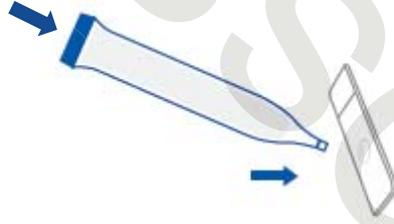
Déposer une goutte d'huile sur la lame en exerçant une brève pression sur la membrane distributrice.
