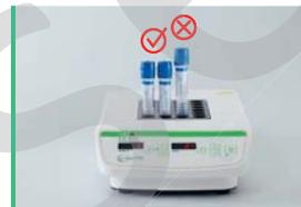
Placez les tubes à essai complètement dans les puits de l'incubateur
