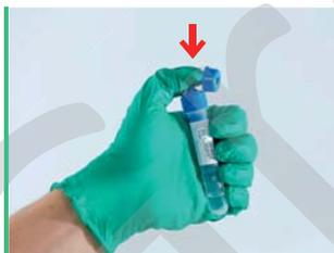
Ouvrez le couvercle de protection et appuyez fermement sur le bouton pour libérer les comprimés AquaSpark™ et Lysis
