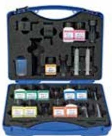
Mallette d'analyse de l'eau pour les écoles contenant le nécessaire pour la détermination du pH, de la dureté totale ainsi que la teneur en nitrate, nitrite, ammonium et phosphate.
